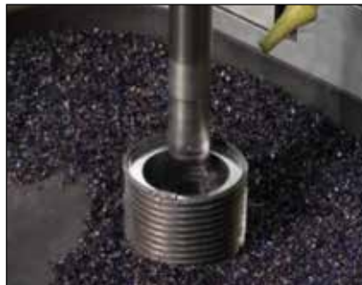
▲ Ausbohren der Mitte eines Bolzens (kleiner Durchmesser).
