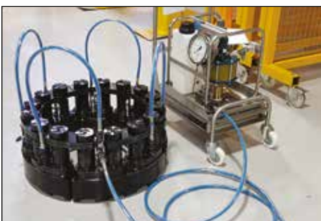
◀ Mit dem Vorspannsystem für mehrere Bolzen (Multi Stud Tensioning, kurz: MST) von Enerpac kann jeder einzelne Bolzen einer Verbindung gleichzeitig gespannt werden.
