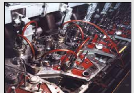
▲ Hydraulikmuttern an einem Dieselmotor.
