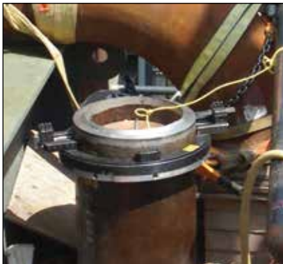
◀ Rohrtrenner der NB Narrow Body-Serie (Schmalbauweise).
