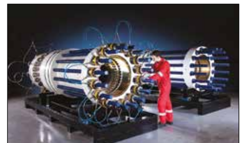
▲ Verbunden mit Schläuchen der HT-Serie bringen Unterwasser-Vorspannzylinder von Enerpac eine gleichmäßige Schraubenbelastung auf.
