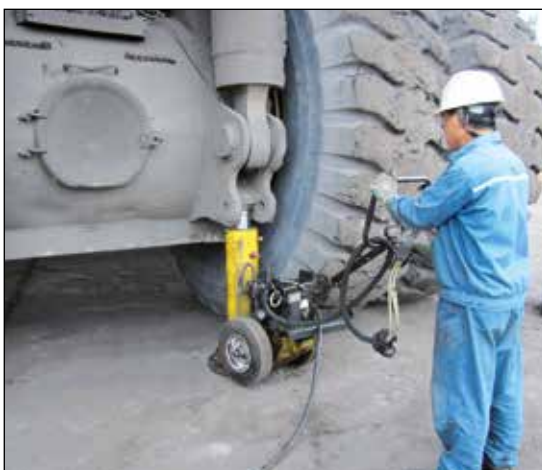
◀ Enerpac POW'R-RISER® kommt beim Bergbau zum Heben von schwerem Gerät zum Einsatz.
