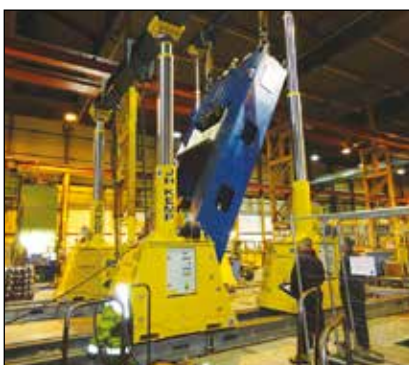
▼ Der Portalkran SL400 wird zum Abladen und zur Montage einer Formpresse eingesetzt.
