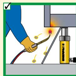
◀ Halten Sie die Hydraulikausrüstung fern von offenem Feuer und Temperaturen von über 65 °C (150 °F).
