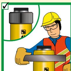
◀ Schützen Sie die Gewinde der Zylinder, da sie zum Befestigen von Zubehör erforderlich sind.
