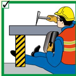
◀ Arbeiten Sie nie unter Lasten. Die Last muß abgestützt sein.
