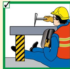
◀ Arbeiten Sie nie unter Lasten, die von Zylindern gehoben werden. Die Last muß abgestützt sein.
