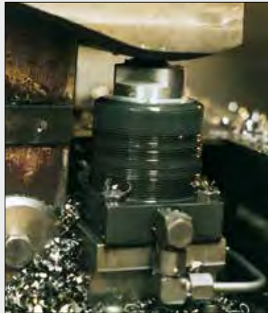
Abbildung: WFL-112 fixiert Gussteile.
